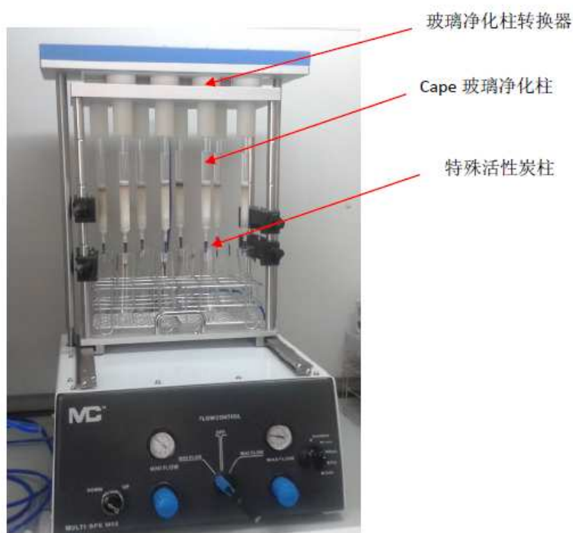
MULTI-CLEANER M08 正压净化装置用于二恶英/PCBs/PBDEs 样品净化
